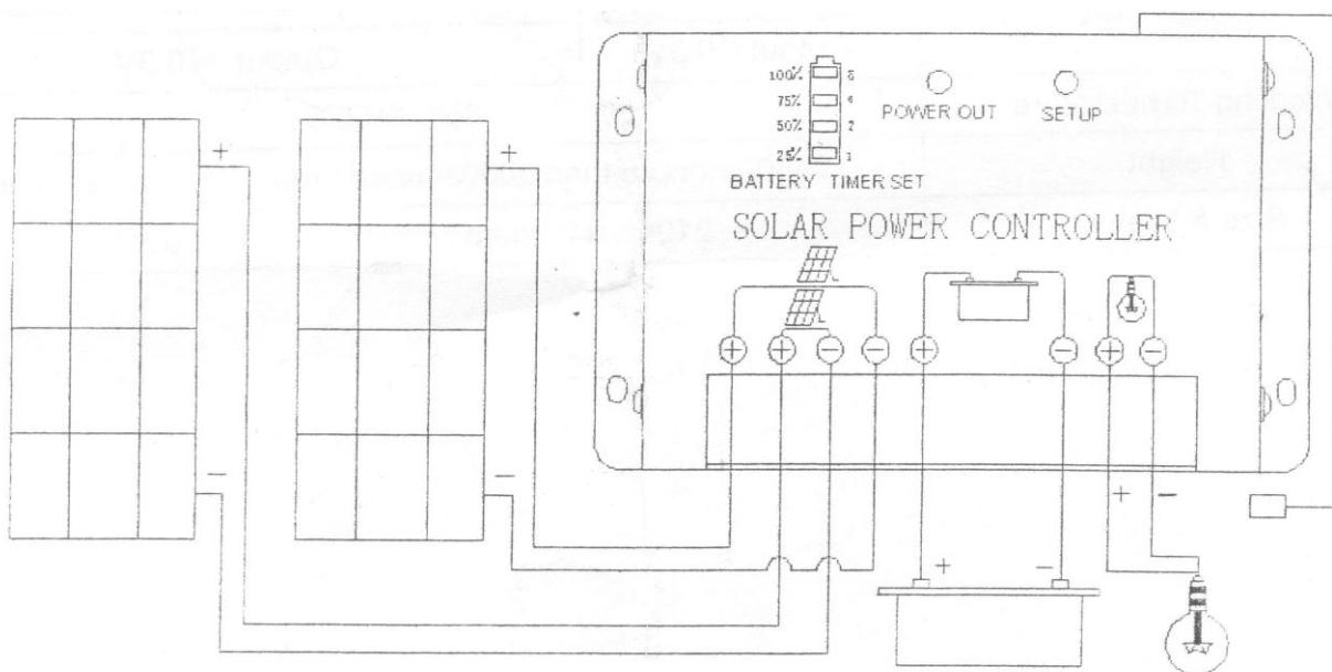
Пожалуйста, не путайте полярность («+» и «-»). Последовательность подключения такова: в первую очередь подключайте аккумулятор, затем солнечные панели; нагрузку подключайте в последнюю очередь.
